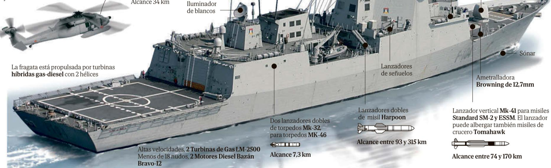
La fragata está propulsada por turbinas híbridas gas-diesel con 2 hélices
